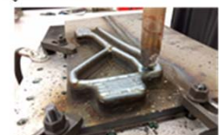
Drahtbasierter 3D-Druck mittels CMT-Verfahren
