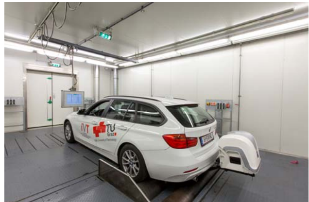
Emissionsuntersuchungen am Rollenprüfstand und mit OnBoard Messtechnik
