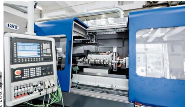
CNC-Forschungsschleifmaschine – weltweit einzigartige Spitzentechnologie für 3D-Unrund-Geometrien (ProLab)
