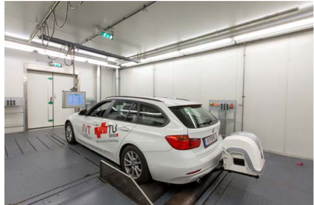
Emissionsuntersuchungen am Rollenprüfstand und mit OnBoard Messtechnik
