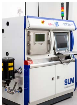
Selektive Laserschmelzanlage (smartfactory@tugraz)
