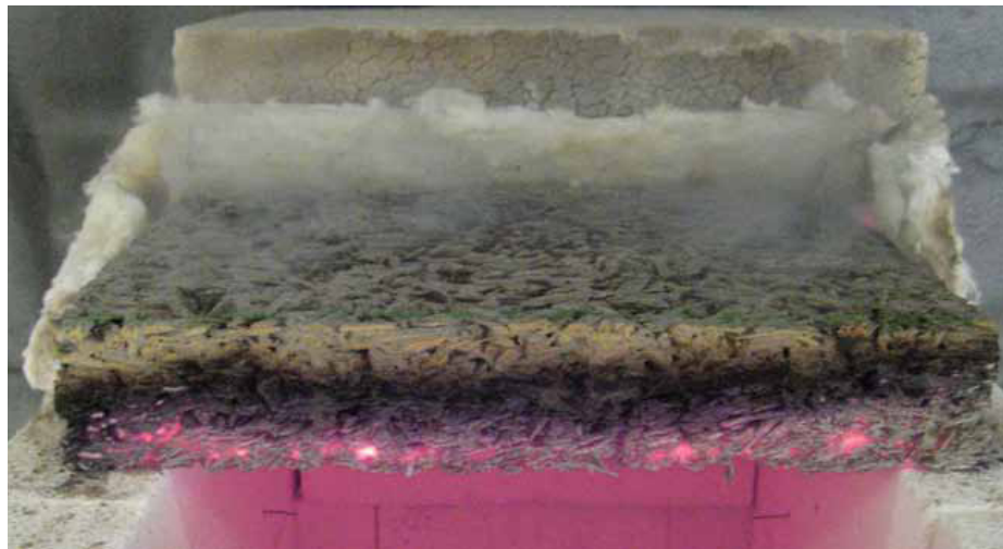
Fire test: Velox; 15min, 30min, 45min
