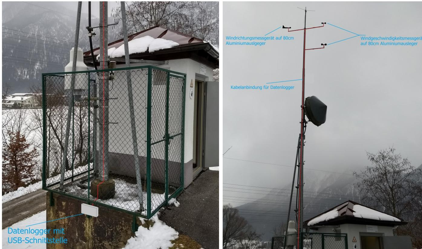
Abbildung 8: Messtation Ebbs (Pegelmessstation)
