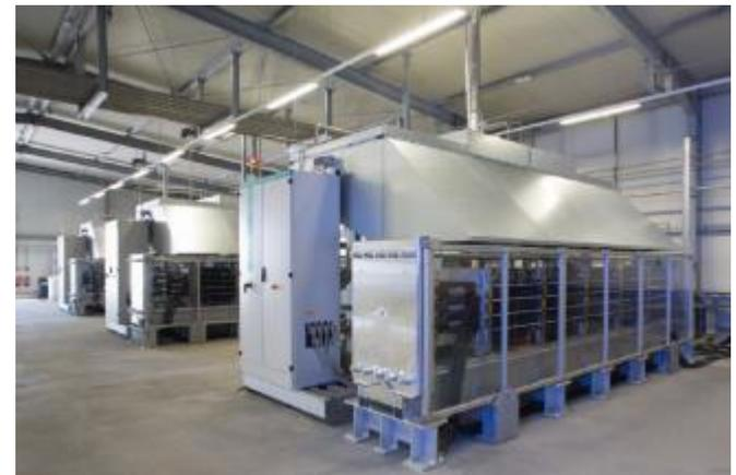
Quelle: Siemens, PEM electrolyser
