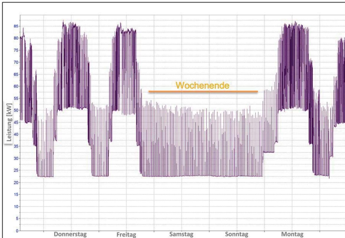
Abbildung 4: Leistungsmessung eines regionalen Industriebetriebes. Die Messung zeigt den Wirkleistungsbedarf der Klimaanlage am Wochenende, die als versteckter Verbraucher bei einer Messung am Hauptstrang nicht aufgefallen wäre (Quelle: eigene Datenerfassung, [18]).
