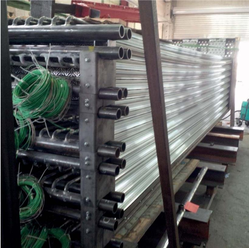
Abbildung 5: Bau des Latentwärmespeichers
