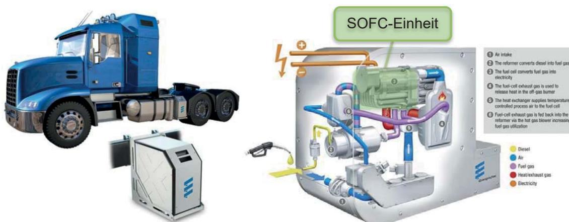
Abbildung 1 Brennstoffzellen-APU [5]
