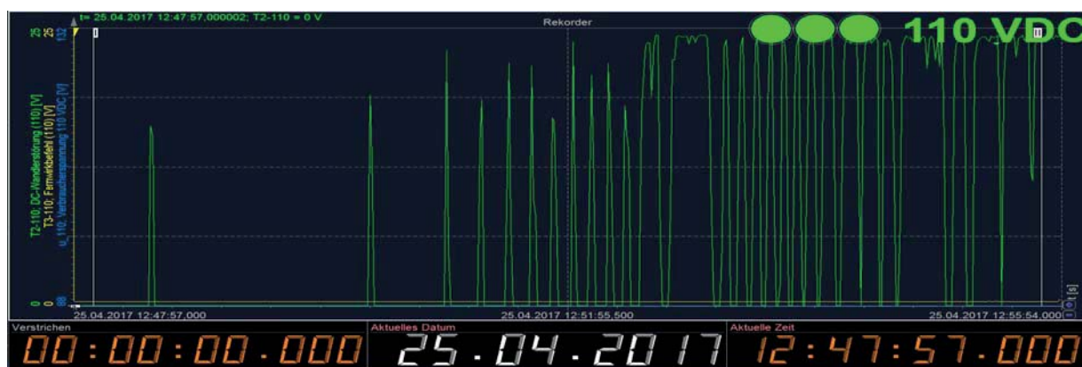
Abbildung 7) Screenshot der DC/DC Wandlerstörungen, mit fortlaufender Zeit kommt es zu einer Häufung von Trigger Ereignissen
