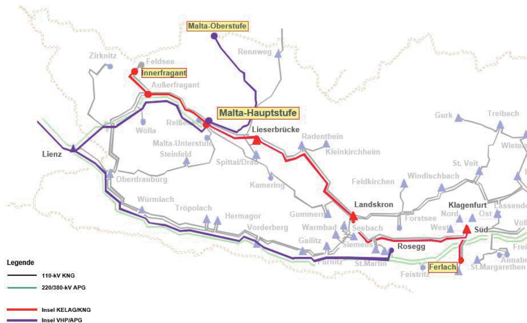
Abbildung 1 Netzübersicht und beteiligte Kraftwerke
