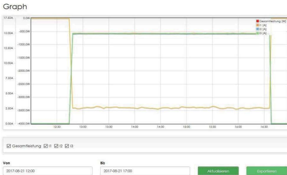
Abbildung 5: Ladevorgang Tesla Modell S: Batteriekapazität 75kWh, dreiphasiges Laden mit 11kW, Ladedauer ca. 4h
