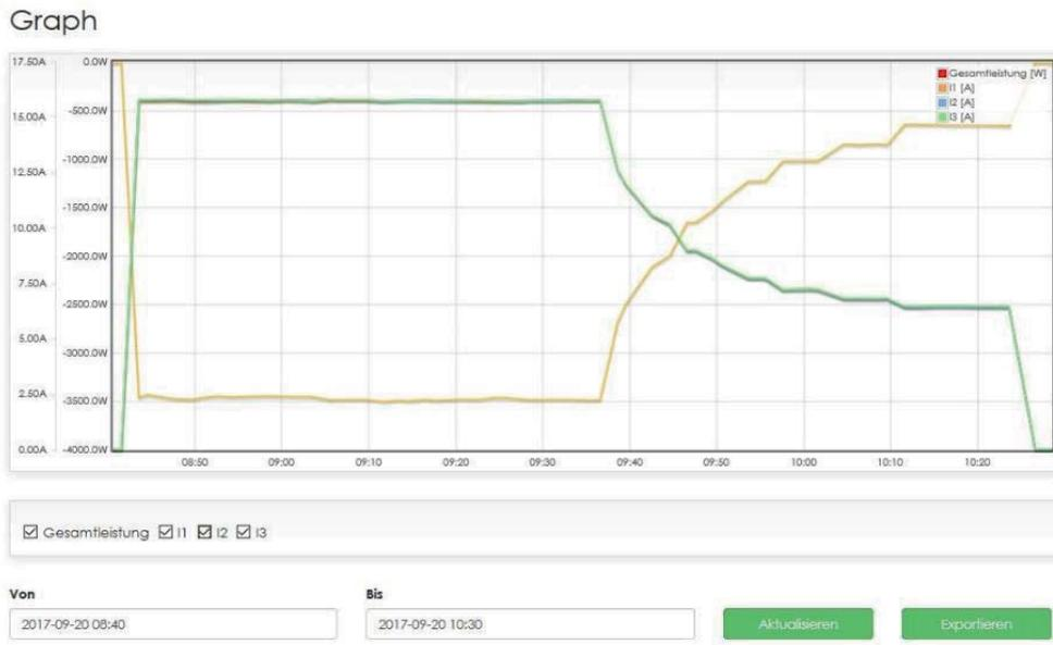
Abbildung 4: Ladevorgang Renault Zoe: Batteriekapazität 22kWh, dreiphasiges Laden mit 11kW, Ladedauer ca. 1h konstant, zum Ende hin abfallende Ladeleistung
