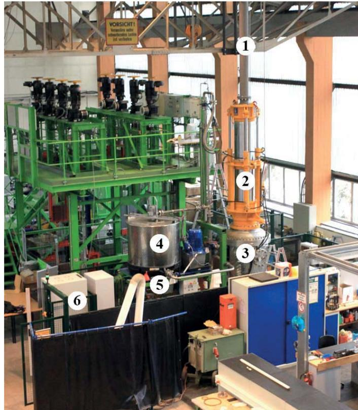
Bild 6: EIV-Versuchsstand der TU Dresden (1 - Prototyp, 2 - Manipulator, 3 - Prüfbehälter, 4 - Spülungstank, 5 - Spülungspumpe, 6 - Steuerungs- und Messsystem)
