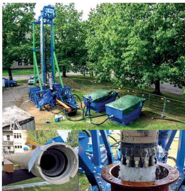
Bild 9: Bohranlage und Bohrkopf (Foto: Detlev Müller / TUBAF Freiberg)
