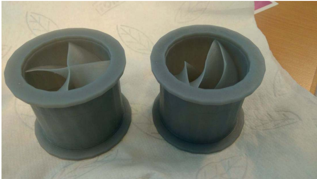
Abb. 7: gedruckter Drallerzeuger X (links) und Drallerzeuger S2 (rechts)
