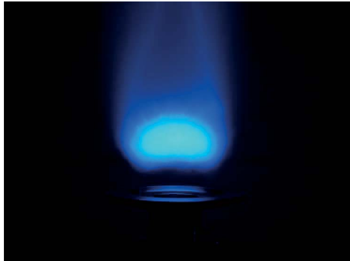
Abb. 2: Drallstabilisierte, vorgemischte Flamme
