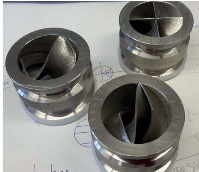
Abb. 8: gedruckte Drallerzeuger X, S1, S2 aus Inconel 718
