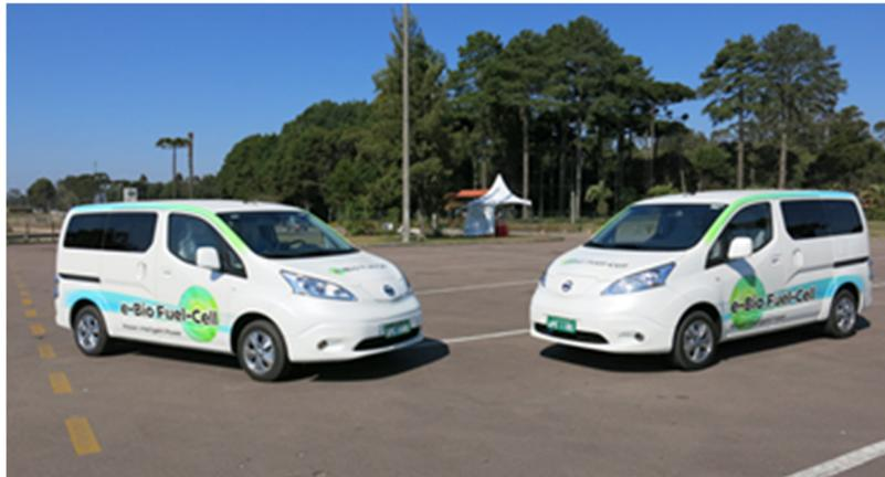
Abbildung 2: Erster SOFC-PKW Prototyp
