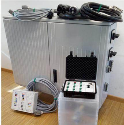
Dieser wird ähnlich einem Adapter zwischen Ladestation und Elektrofahrzeug platziert (CCS- und CHAdeMO-Steckverbinder sind wahlweise möglich) und ermöglicht die Simulation in der Praxis zu erwartenden und daher auch zu überprüfenden Fehlersituationen:
