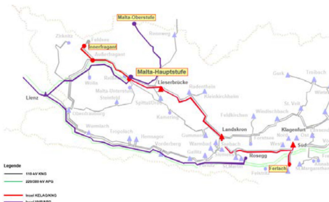
Abbildung 1: Versuchsnetz und beteiligte Kraftwerke, Inselnetzversuche Kärnten 2017
