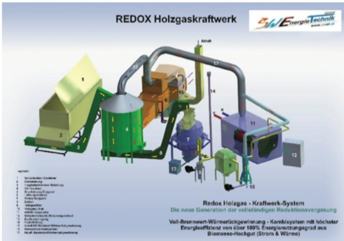
Abbildung 2: REDOX Holzgaskraftwerk
