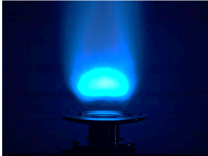
Abbildung 3: Drallstabilisierte, vorgemischte Flamme
