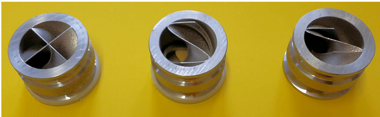
Abbildung 2: Drallerzeuger aus Inconel 718 mit Additive Manufacturing hergestellt
