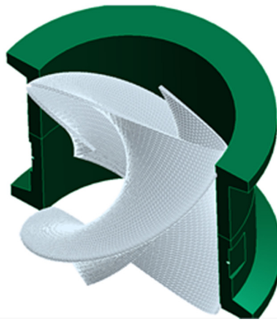
Abbildung 1: 3D Konzept für den Drallerzeuger
