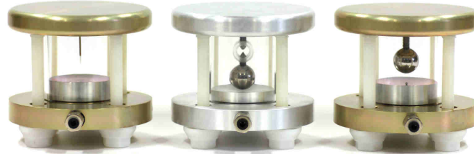
Bild 7: Testzellen mit typischen Defekten (Nadel-Platte, freies Potential, springendes Partikel)
