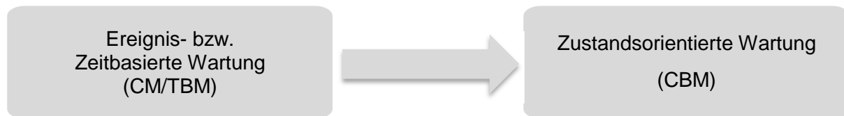
Bild 1: Wechsel der ereignis- bzw. zeitbasierten Wartung zur zustandsorientierten Wartung
