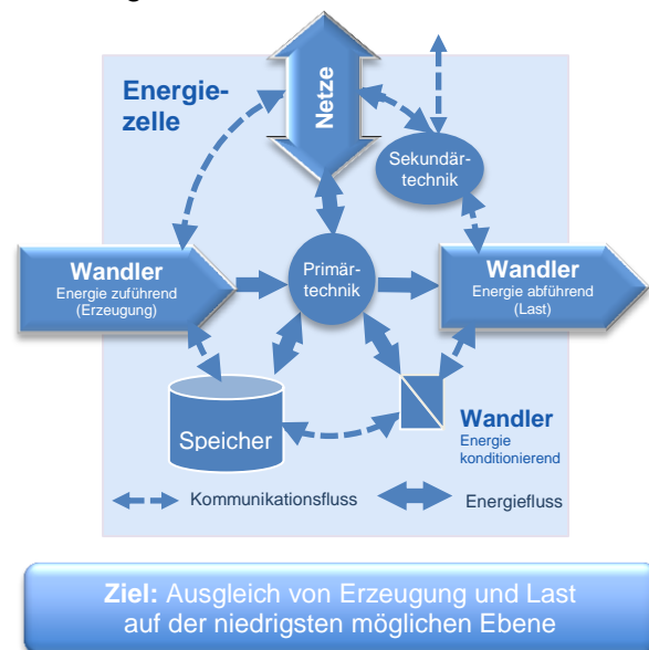
Abbildung 3: Dezentrale Energiewandler der Idee zum „zellulären Ansatz“ [3]
