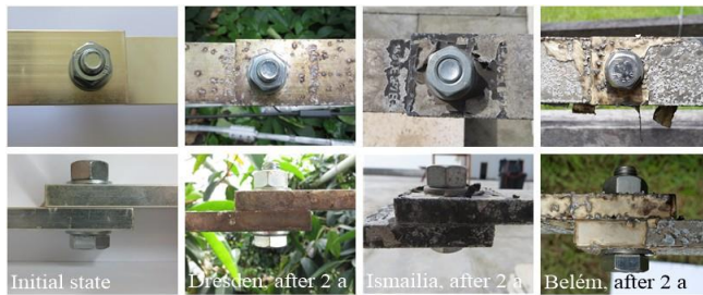
Abbildung 12: Auf der Oberfläche versilberter Kupferstromschiene sind deutliche Veränderungen zu beobachten.
