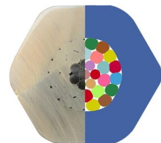
Abbildung 9c: FEM-Modell der Sechskantverpressung im Vergleich zum Schnitt durch eine reale Verbindung
