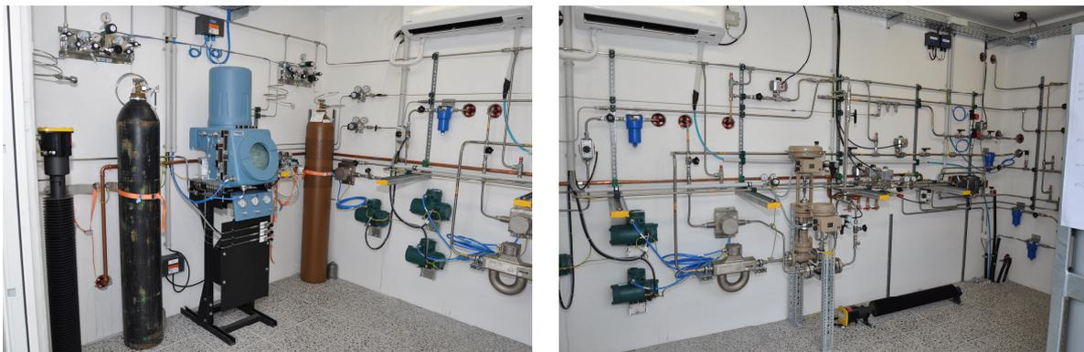
**Abbildung 7: Gaschromatograph und Durchflussmesser (links); Durchflussregler, Mischventil Erdgasleitung (rechts)**
