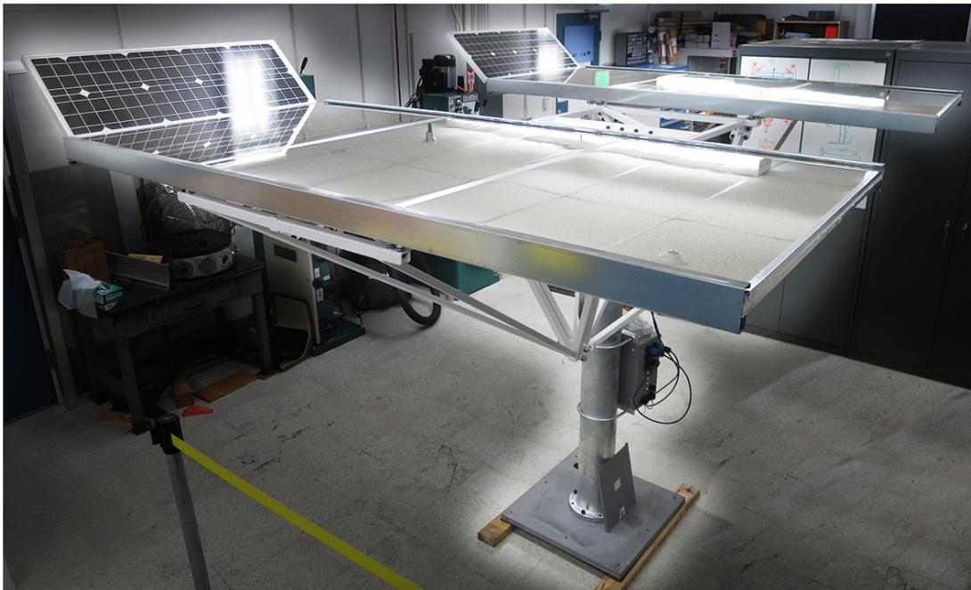
Abbildung 21: Heliostat Prototyp knapp vor der Fertigstellung am NASA Jet Propulsion Laboratory
