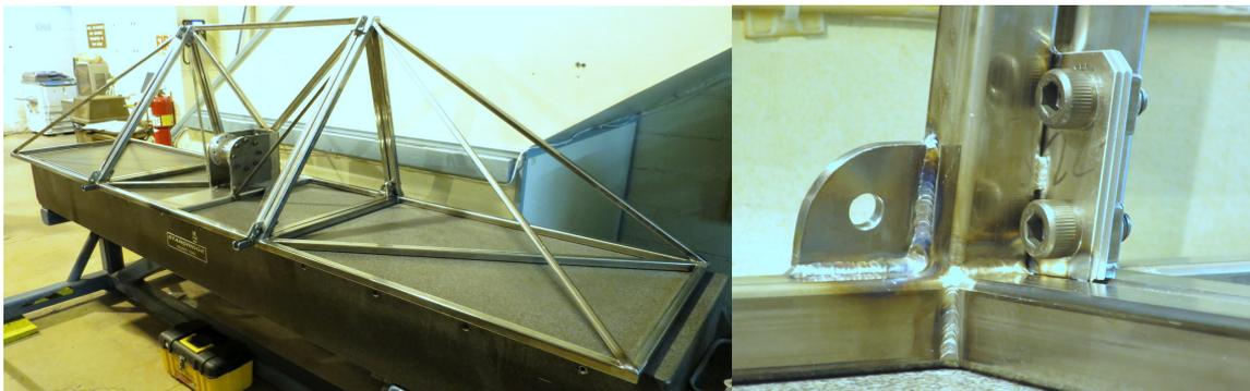
Abbildung 20: Links - Fertig geschweißter und montierter Fachwerksträger bei der Prüfung der Ebenheitstoleranz. Rechts – Detailaufnahme einer der Verbindungsplatten zwischen Wing und Central Hub.
