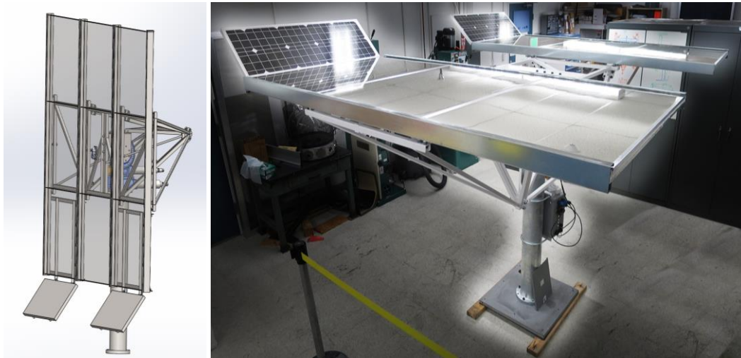
Abbildung 2: CAD-Modell und Foto des JPL Heliostat Prototypen.
