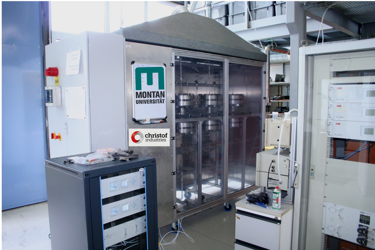
Abbildung 5: Laboranlage zur Methanisierung von CO 2
