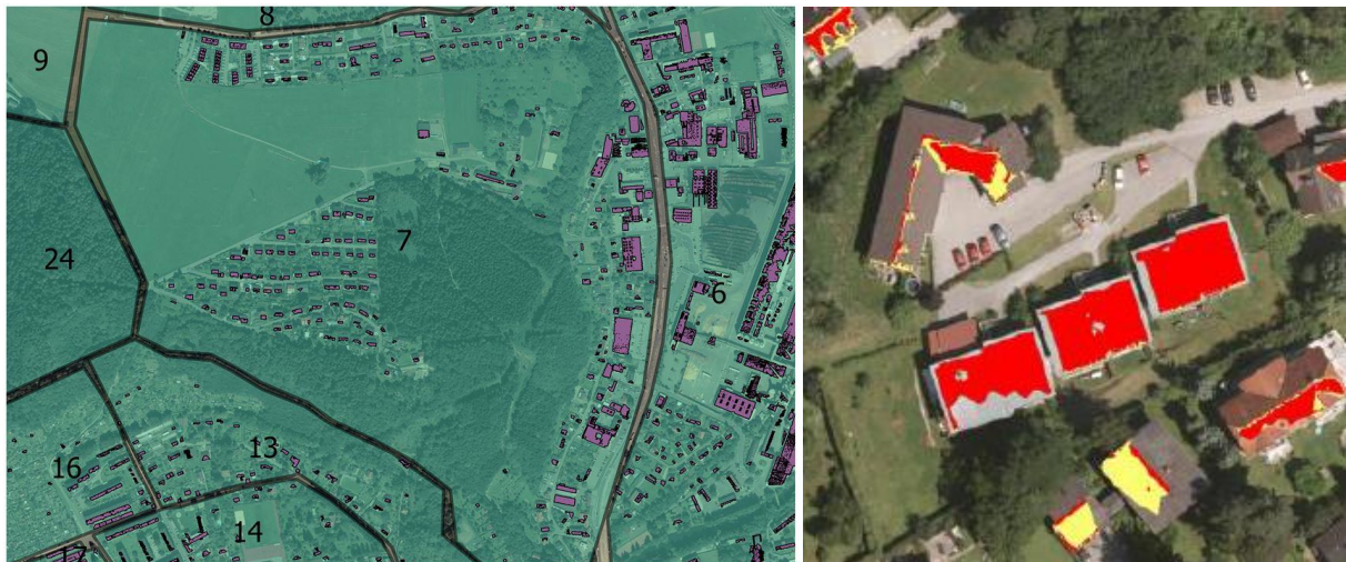
Abbildung 8 Die ermittelten Dachflächen (lila) in Zelle 7 und den angrenzenden Zellen in Bruck an der Mur (links) und deren Klassifizierung in geeignete Flächen für PV in rot (sehr gut geeignet) und gelb (gut geeignet).
