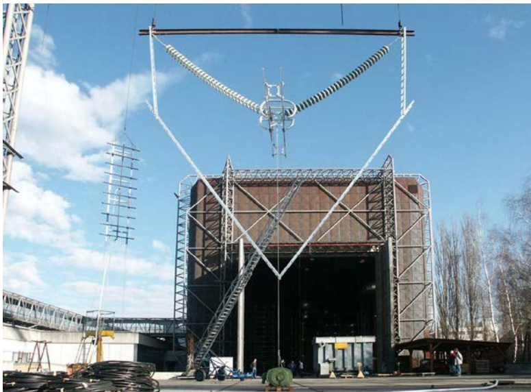
500-kV-HGÜ-Isolatorketten mit Mastnachbildung
