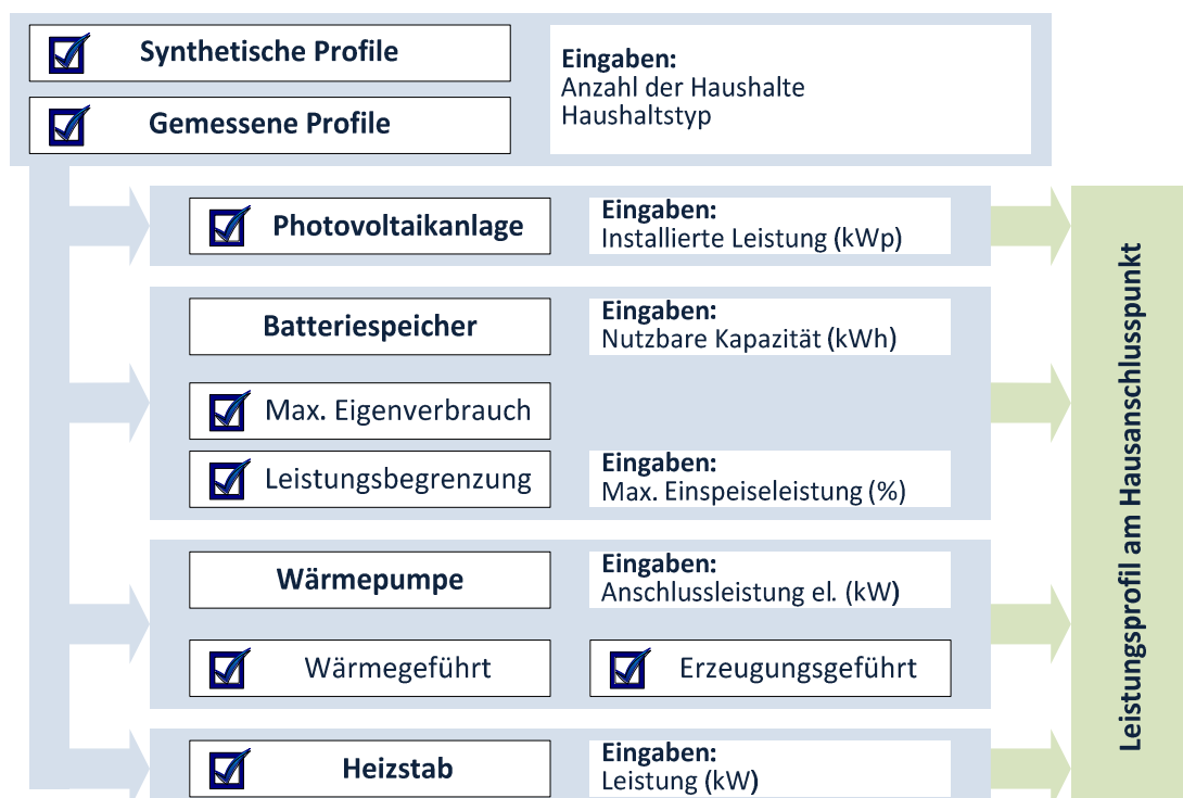
Abbildung 5: Funktionsübersicht des Leistungsflussgenerators.
