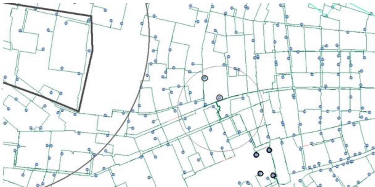
Abbildung 3 Kabel-Ist- Zustand plus einzubindender Trafostationen
