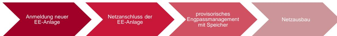
Abbildung 8: Engpassmanagement als Provisorium zwischen Netzanschluss und -ausbau
