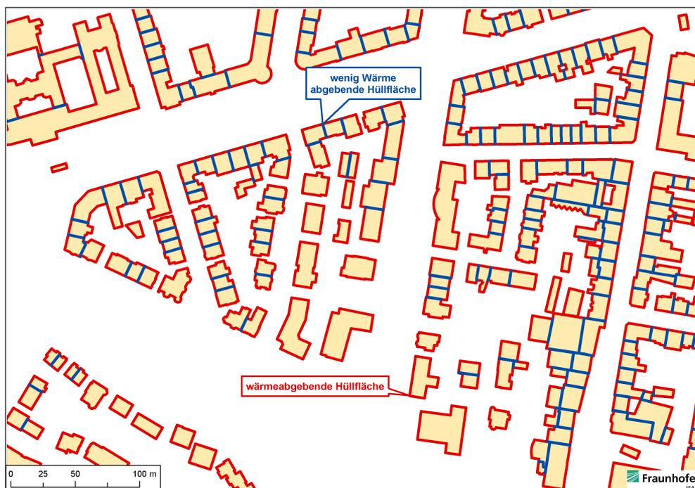
**Abbildung 3: Berechnung eines modifizierten A\*/V-Verhältnisses für jedes Gebäude unter Berücksichtigung der individuellen baulichen Umfeldsituation**
