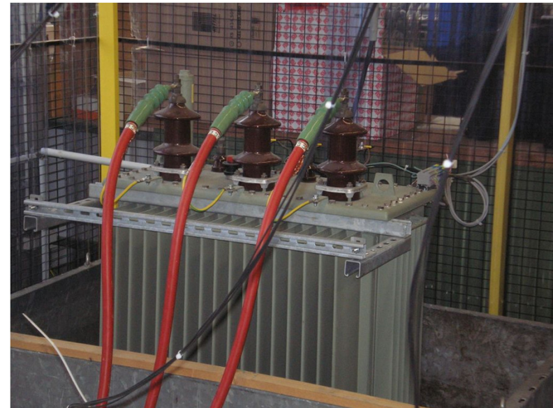
10 kV – Testaufbau für 3 KLMs
