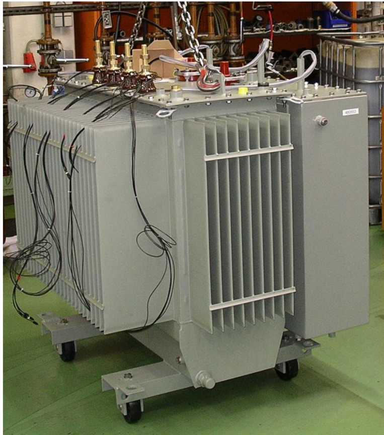
Transformator und eingebaute Kompaktleistungsmodule
