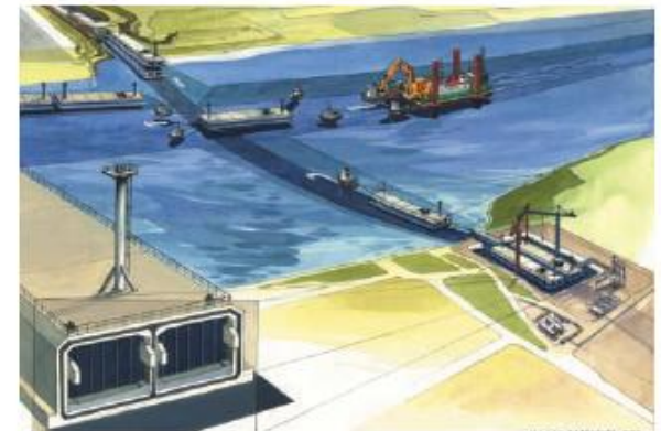
Abb. 2 c: Die abgeschotteten Röhren werden abgesenkt und positioniert
