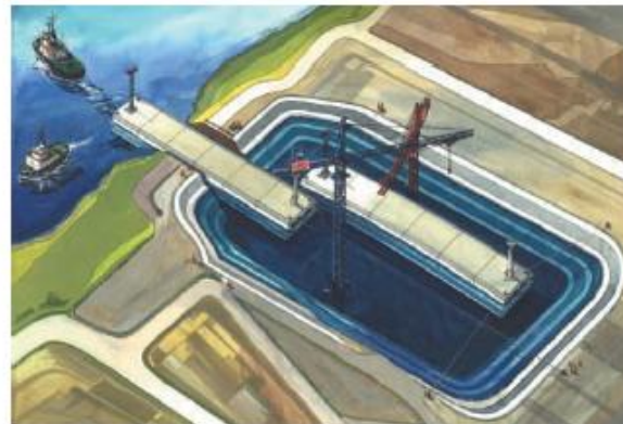
Abb. 2 b: Nach der Flutung des Baudocks erfolgt das Ausschwimmen der Röhren
