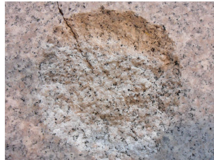
Bild 8: Gesteinsabtrag mit 8"-Elektrode
