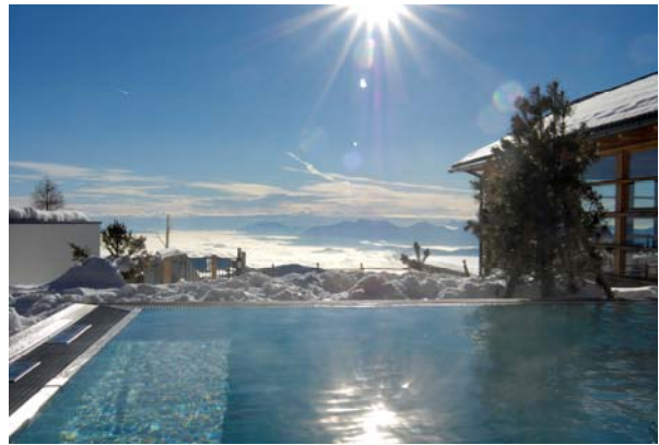
Abbildung 3: Außenbecken des HOTELS FEUERBERG, Gerlitz: das Wasser wird in der Nacht in ein wärmeisoliertes Becken im Technikraum gepumpt, um die Energieverluste des Außenbeckens zu verringern, Solaranlage von ca. 100 m 2 Wasserwärmung.
