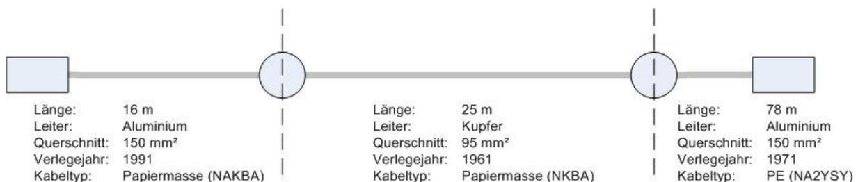
Abbildung 4: Segmentierte Kabelanlage mit Muffen (rund) und Endverschlüssen (rechteckig).
