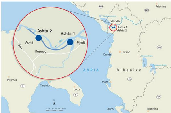
Das Kraftwerk Ashta ist die letzte Kraftwerksstufe in einer Reihe von bestehenden Kraftwerken und nutzt die Fallhöhe zwischen dem vom Fluss Drin gespeisten Spathara-Stausee und der Mündungsstelle des Drin in die Buna. Das Einzugsgebiet umfasst 11.500km<sup>2</sup>, der mittlere Abfluss beträgt rund 310m<sup>3</sup>/s. Es handelt sich um ein 2-stufiges Ausleitungskraftwerk, das zum Teil vorhandene Anlagenteile nutzt.
