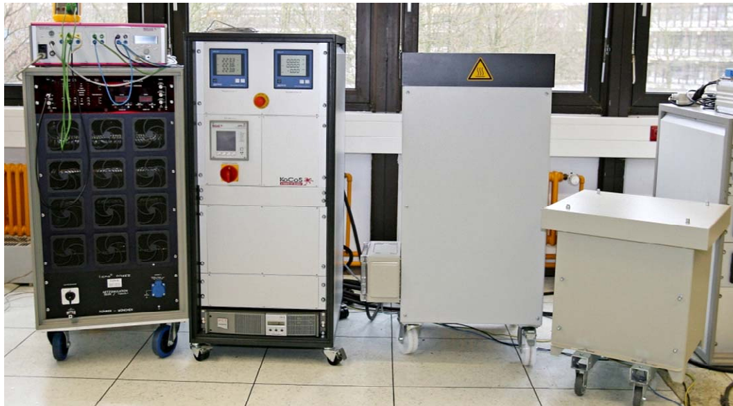
Signalgenerator Hauptterminal Leistungswiderstand Leistungsverstärker Leistungsinduktivität
