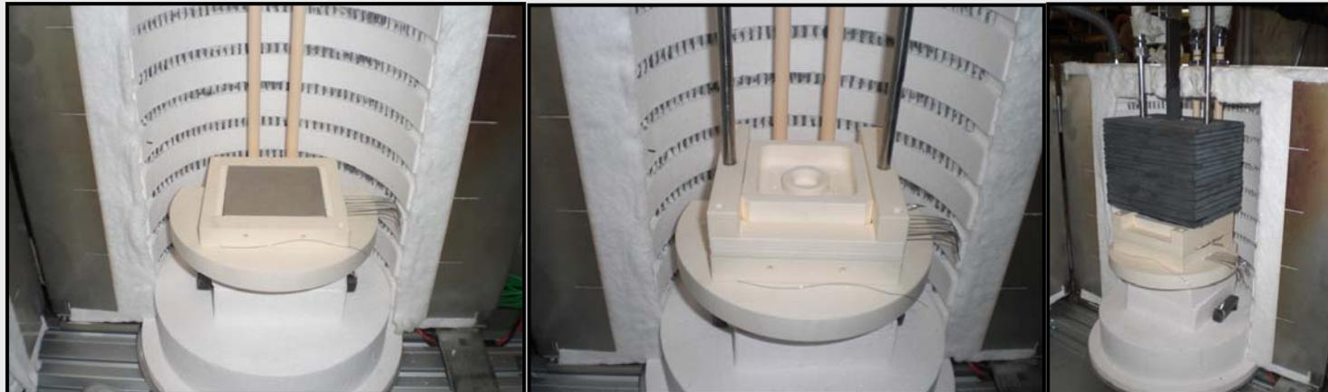
**Keramikgehäuse für planare 10x10cm<sup>2</sup> SOFC-Einzelzellen**
