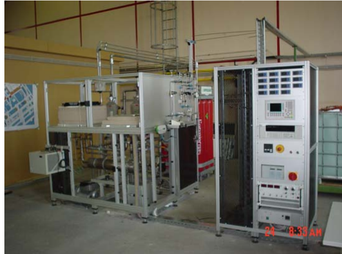
Bild 2: Brennstoffzellenteststand im Innovationszentrum der STEAG Saar Energie am Standort Luisenthal
