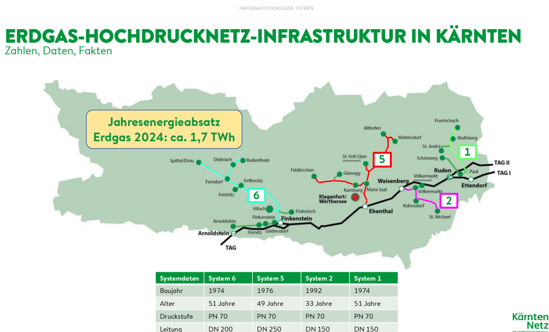
Abbildung 2: Erdgas-Hochdrucknetz-Infrastruktur in Kärnten
