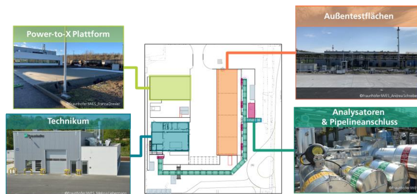
Abbildung 1: Hydrogen Lab Leuna: im Technikum befinden sich unterschiedliche Teststände bis zu einer Leistungsklasse von 46 kW, auf den Außentestflächen können Anlagen im Industriemaßstab bis 5 MW erprobt werden.
