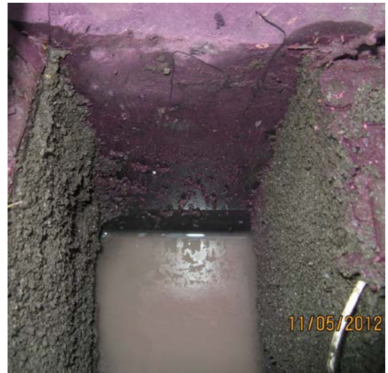
Bild 1: Durchströmung im Tracerversuch
