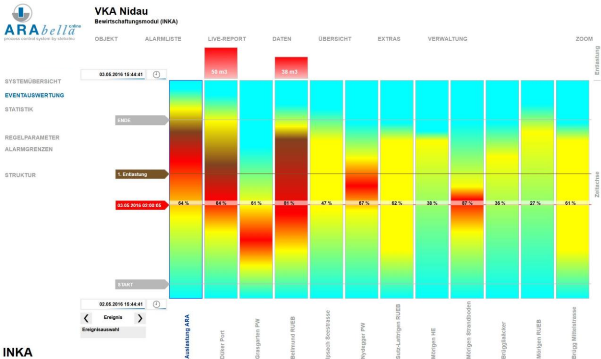
Abbildung 1: Be- und Entlastungsmengen beim Betrieb unterschiedlicher Bauwerkskomponenten im Netz Biel. Im zeitlichen Verlauf kann von unten nach oben der Füllstand abgelesen werden (blau tief, rot hoch, braun Überlauf). Zu erkennen ist, dass Speichervolumen bereits verbraucht wurde, während die Kläranlage noch nicht zu 100% hydraulisch ausgelastet war. Respektive, dass durch eine dynamische Anpassung der Weiterleitmengen die Überläufe hätten verhindert werden können.
