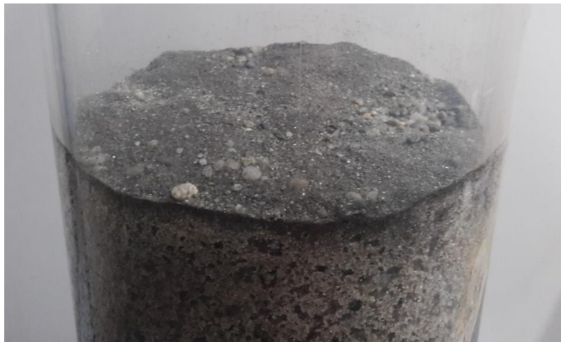
Abbildung 5: Ablagerungen von Feinstoffen auf der Sandschicht nach Simulation des 11. und 12. Betriebsjahres mit abgesetztem Straßenabwasser.
