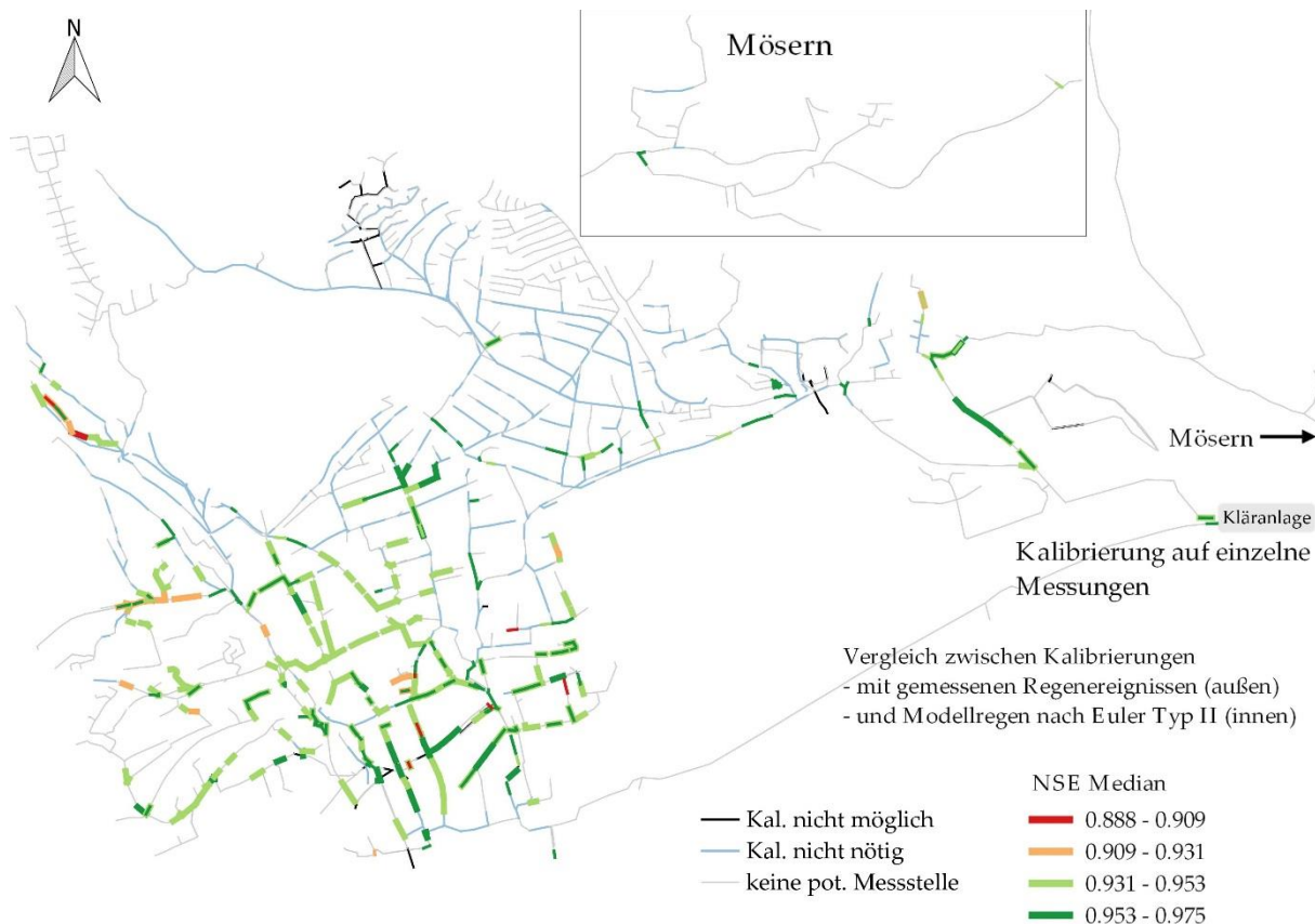
Abbildung 6: Ergebnis der Kalibrierungen auf einzelne Messstellen (äußere Linie je Leitung: Kalibrierung mit gemessenen Regenereignissen; innere Linie je Leitung: Kalibrierung mit Modellregen nach Euler Typ II)
