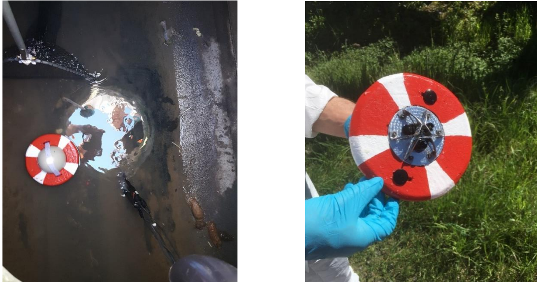
Abbildung 13: Sewer-Ball Versuche im Kanal mit Schwimmhilfe.
