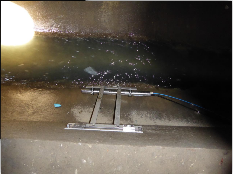
Installation von Spektrometersonden im Trennbauwerk der Regenüberlaufbecken
