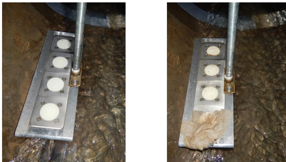
Abbildung 8: Darstellung der Installation der Passivsammler an Messstandort 1 vor und nach dem Ereignis vom 18.05.2016.
