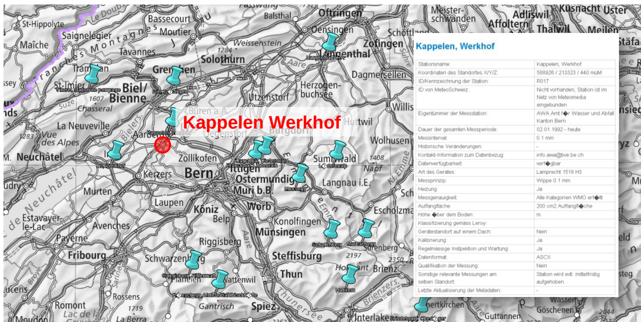
Abbildung 3: Ein Beispieleintrag zeigt die aktuellen Informationen zur Station Kappelen Werkhof, die vom AWA Amt für Wasser und Abfall des Kantons Bern seit 1992 betrieben wird. Zum gegenwärtigen Zeitpunkt sind ca. 50 Messtationen erfasst. Meta-Daten von 420 Stationen sind vorhanden und werden zeitnah eingepflegt.
