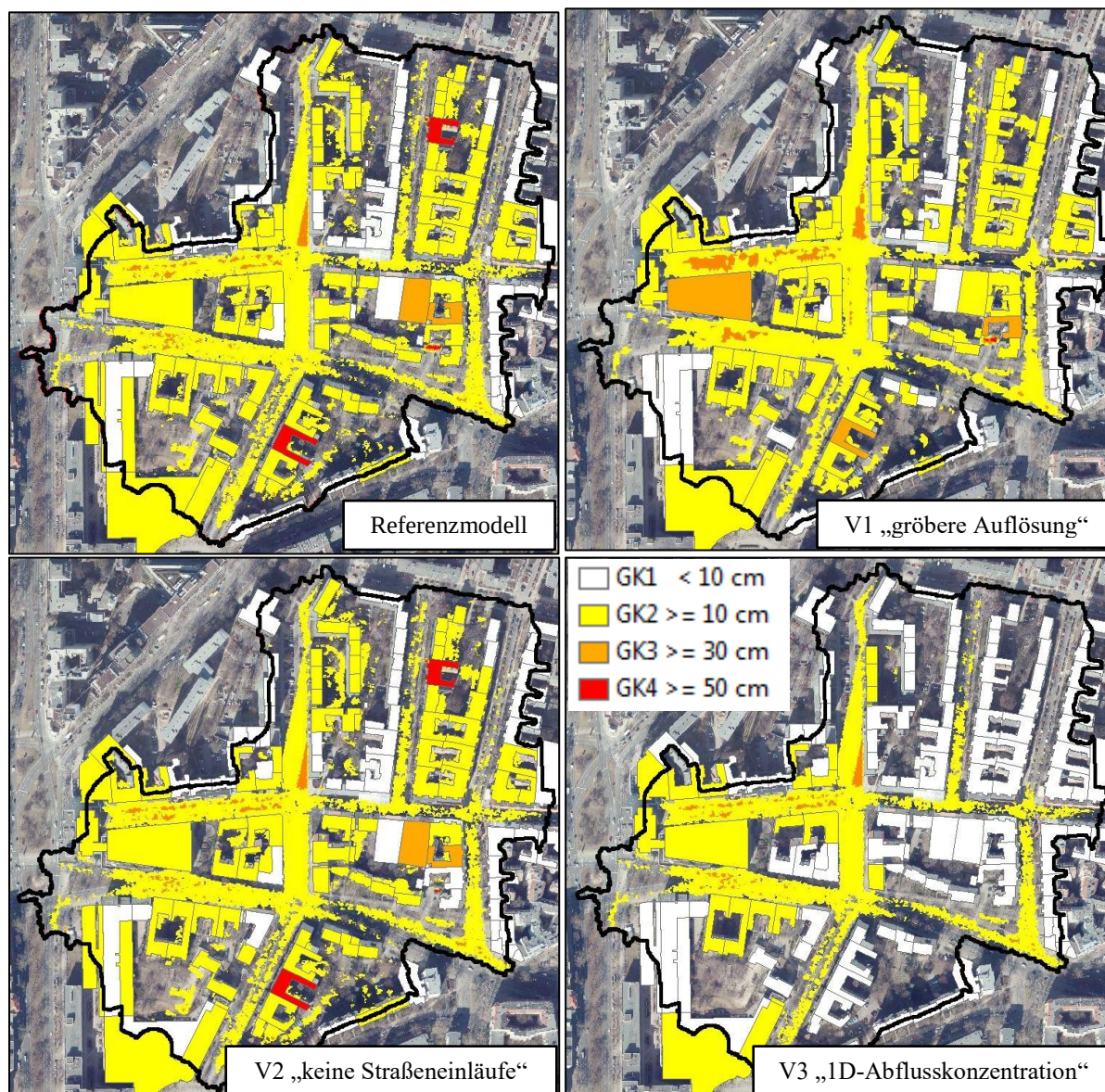
Abb. 2: Gefährdungsdarstellung für Referenzmodell und Varianten – max. Wasserstand/Gefährdungsklassen
