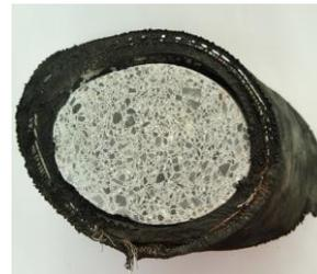
Abbildung: QS eines Pumpschlauchs und darin ausgehärtetem Beton
