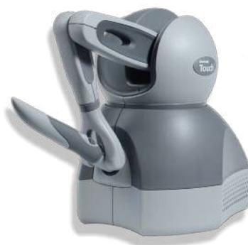
**Abb. 6.2.2:** Geomagic Touch Haptischer Roboter
