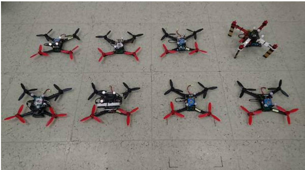
**Abb. 7.1.1:** Die neuen Drohnen des droneSpace. 8 der 10 Drohnen wurden bereits fertiggestellt und sind in Verwendung. Die Drohnen sind je nach Aufgabe mit unterschiedlichem Kamerasystem ausgestattet. Es gibt zwei Bauformen, eine für Innenraum-Flüge und eine größere Bauform, die auch für den Außenbereich geeignet ist. Alle Drohnen besitzen leistungsfähige Onboard-Computer für Echtzeitbildverarbeitung. Alle Drohnen können über ROS (Robot Operating System) drahtlos angebunden werden.
