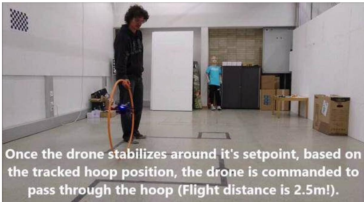
**Abb. 7.1.4:** Student der VU Kameradrohen bei seiner Projektarbeit. Die Drohne erkennt den Hula-Hoop-Reifen mittels der Tiefenkamera an Bord und berechnet dann einen Flugpfad um durch den Reifen durchzufliegen.
