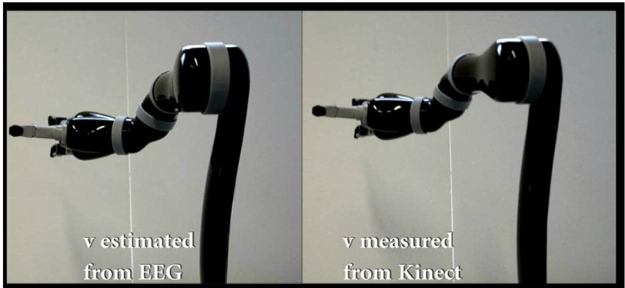
**Abb. 6.3.2:** Bewegungstrajektorien werden entweder direkt (links) oder aus dem EEG-berechnet nachgefahren.
